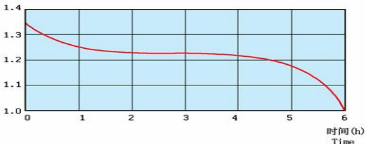
袋式铁镍蓄电池0.2C 5 A放电曲线(25℃)
